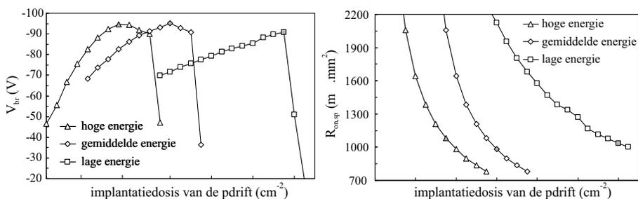
**Figuur 23**  $V_{br}$  (links) en  $R_{on,sp}$  i.f.v. de implantatiedosis voor verschillende implantatie-energieën. Gevulde datapunten tonen de optima.
