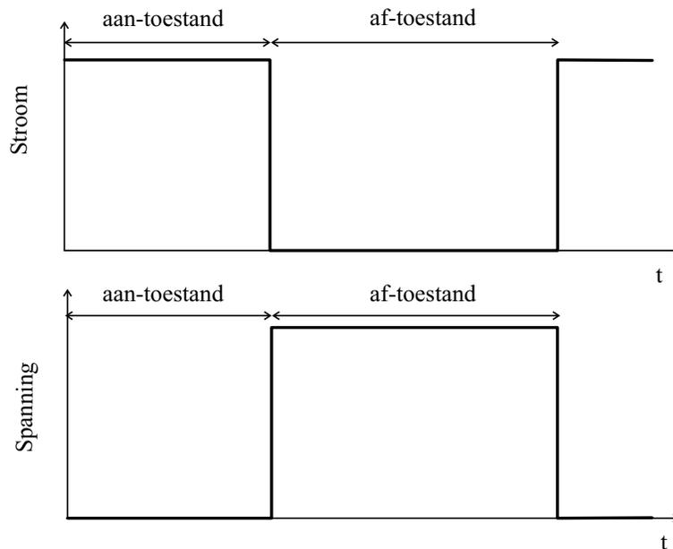
**Figuur 1** Stroom- en spanningsverloop van een ideale vermogensbouwsteen.
