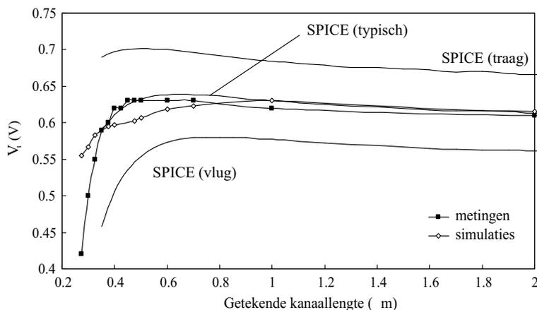
**Figuur 11**  $V_t$  in functie van getekende kanaallengte: vergelijking tussen metingen, SPICE- en TCAD-simulaties.
