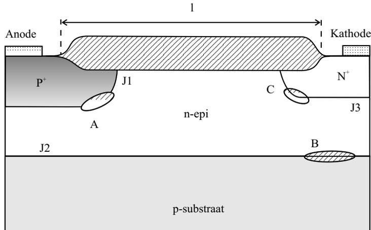
**Figuur 12** Een RESURF-diode.
