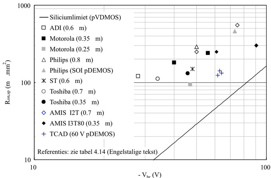
**Figuur 36** De I3T80 pLDEMOS i.v.m. de concurrentie en de siliciumlimiet.
