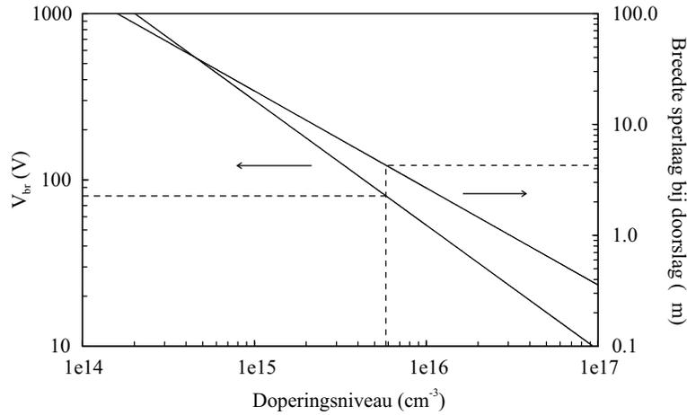
**Figuur 3** Doorslagspanning  $V_{br}$  en breedte van de sperlaag bij doorslag als functie van het doperingsniveau van het laag gedopeerd gebied van  $n^+p$ -diode.
