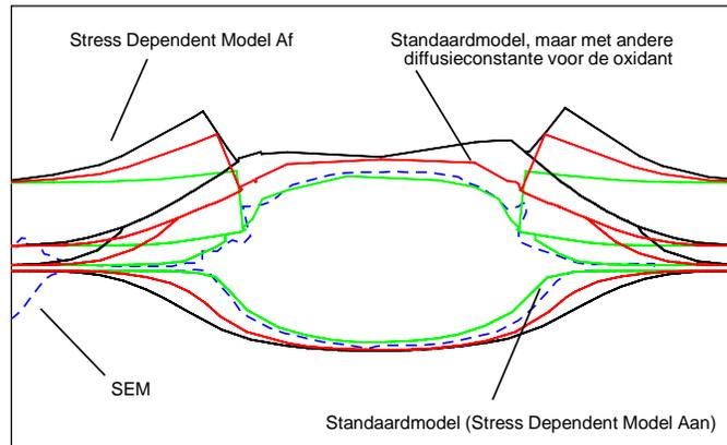
**Figuur 8** Vergelijking van verschillende oxidatiemodellen met een SEM-foto.
