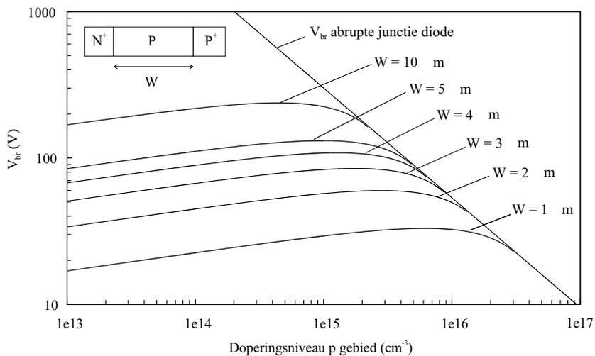
**Figuur 4**  $V_{br}$  voor een abrupte junctie diode en voor PT-diodes met verschillende breedtes. De inzet toont een PT-diode.
