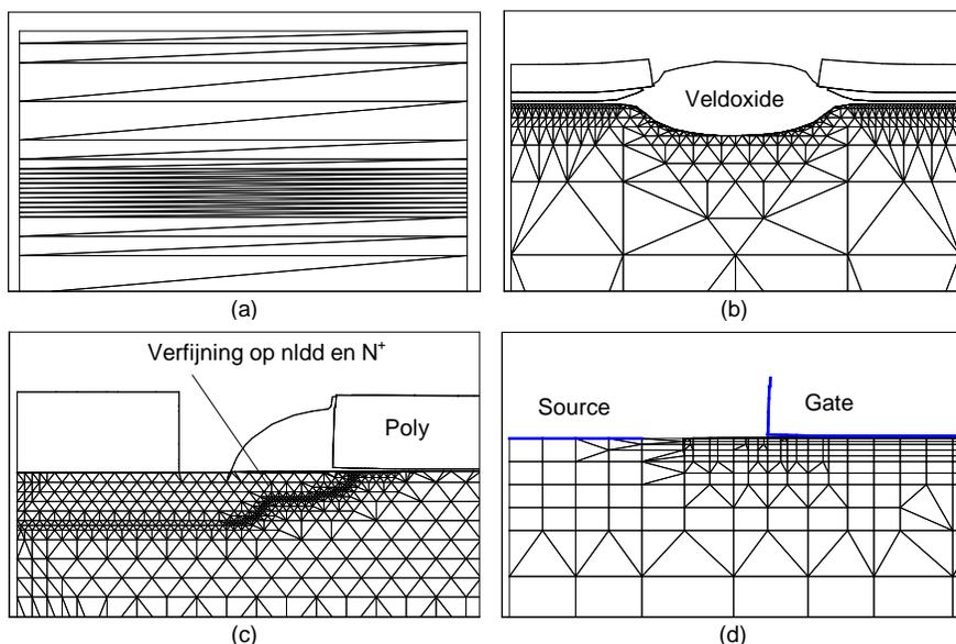
**Figuur 6** Evolutie van het raster doorheen de simulatie: (a) 1D in proces simulatie, (b) eerste proces stap in 2D, (c) op het einde van het proces en (d) nieuw raster voor simulatie van de werking van de transistor.
