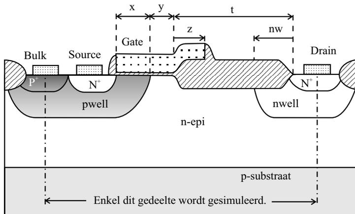
**Figuur 15** De niet-zwevende, laterale RESURF nDEMOS met belangrijkste lay-outparameters.
