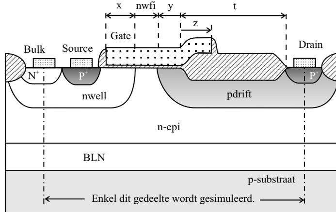
**Figuur 22** De zwevende, laterale RESURF pLDMOS met de meest belangrijke lay-out parameters.
