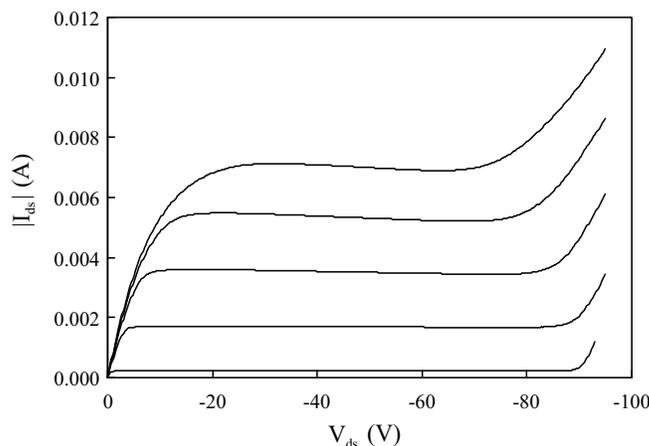
**Figuur 24** *Gemeten  $I_d(V_{ds})$  voor  $V_{gs} = -1.1, -2.2 \dots -5.5$  V van een pLDE-MOS (breedte  $W = 40 \mu\text{m}$ ) onder optimale RESURF-condities.*
