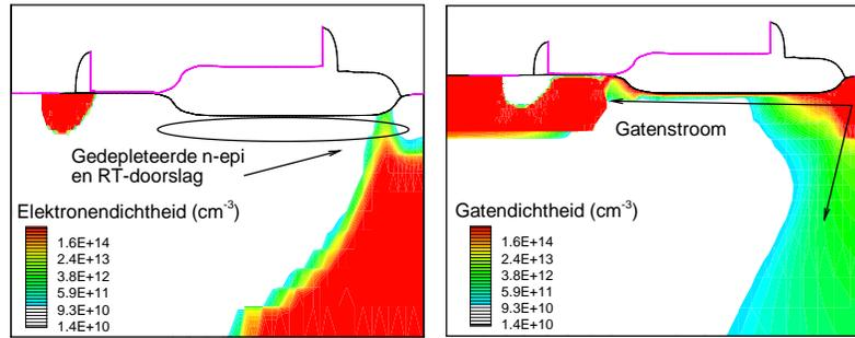
**Figuur 26** Elektronen- en gatendichtheid bij doorslag (voorwaarts, i.e.,  $V_{ak} > 0$  V) voor een IGBT zonder begraven lagen.
