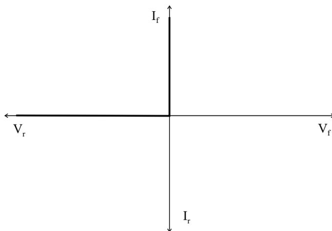
**Figuur 2** Uitgangskarakteristiek van een ideale gelijkrichter.
