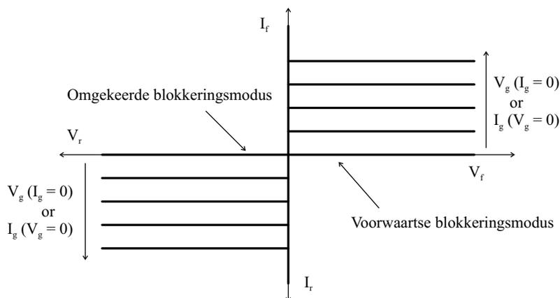
**Figuur 5** Uitgangskarakteristieken van een ideale schakelaar.
