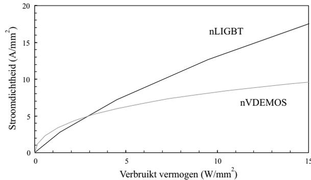
**Figuur 32** *Gemeten* stroomdichtheid versus verbruikt vermogen per oppervlakte-eenheid bij  $V_{gk} = 3.3 \text{ V}$  voor de LIGBT van figuur 31, vergeleken met een typische VDEMOS ( $V_{gs} = 3.3 \text{ V}$ ).
