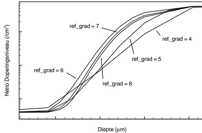
**Figuur 7** Invloed van de verfijning van het raster (Refgrad) op een doperingsprofiel.
