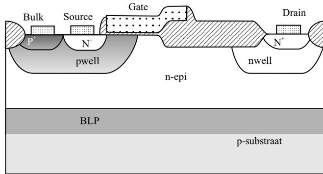
**Figuur 16** De niet-zwevende, laterale RESURF nDEMOS op een BLP.
