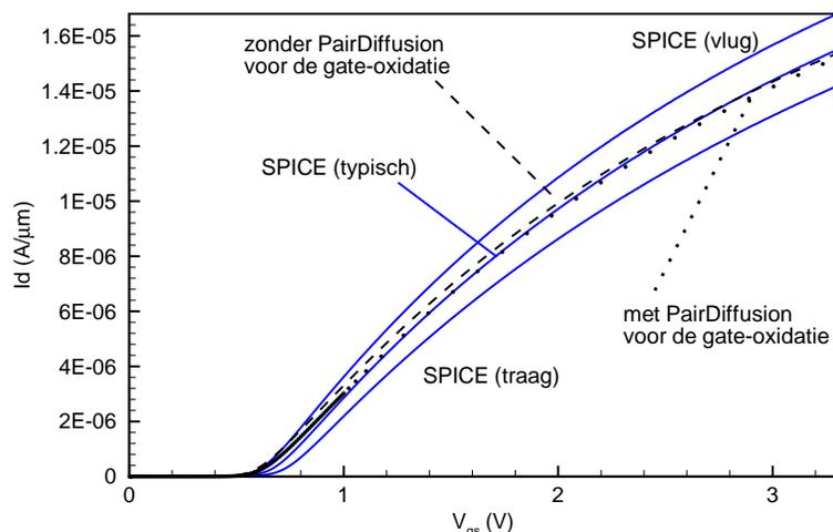
**Figuur 10**  $I_d(V_{gs})$  voor een nMOS met getekende kanaallengte van  $2\ \mu\text{m}$ : SPICE-simulaties versus TCAD-simulaties.
