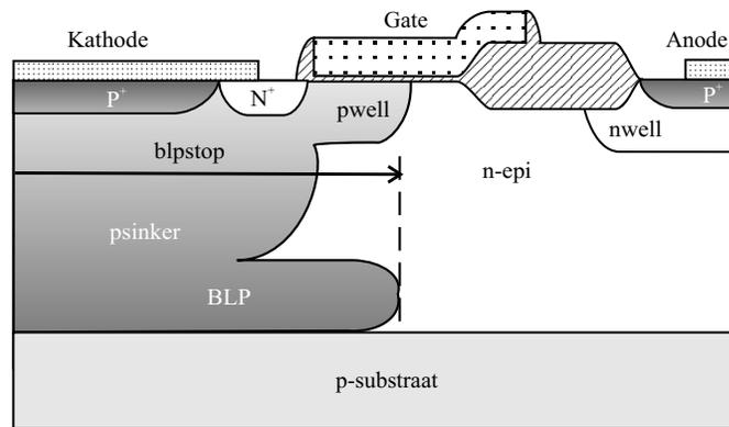
**Figuur 29** De niet-zwevende nLIGBT met BLP en psinker.
