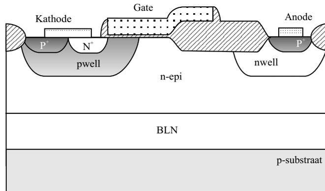
**Figuur 27** Een IGBT met BLN en nwell.
