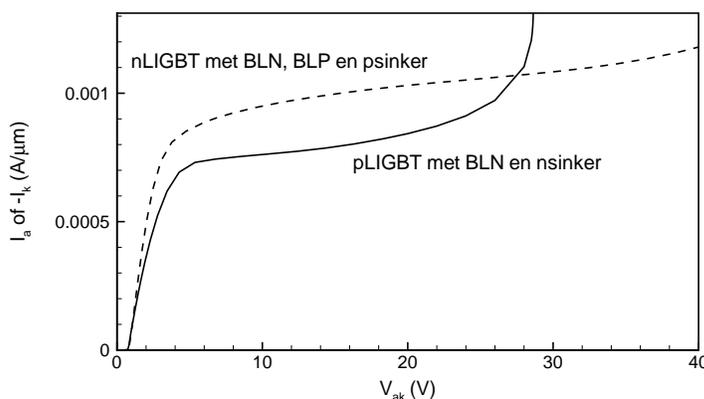
**Figuur 35** Uitgangskarakteristiek van een pLIGBT (voor  $V_{ga} = -3.3 \text{ V}$ ) met  $blnend = 0 \mu\text{m}$  vergeleken met een nLIGBT (voor  $V_{gk} = 3.3 \text{ V}$ ) met een zwevende BLN, BLP en psinker.
