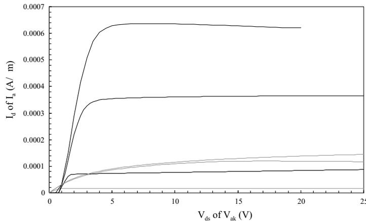
**Figuur 31** *Gemeten* uitgangskarakteristieken voor  $V_{gk} = 1.1, 2.2$  en  $3.3 \text{ V}$  voor een LIGBT met BLN en BLP vergeleken met een typische VDEMOS (grijs, met  $V_{gs} = 1, 2$  en  $3.3 \text{ V}$ ).
