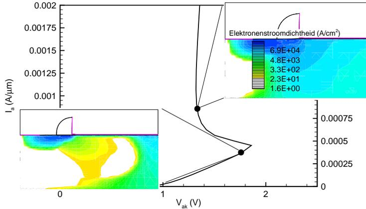
**Figuur 28** Terugslag bij  $V_{gk} = 3.3 \text{ V}$  voor de LIGBT uit tabel 3 met een nbufferdosis gelijk aan  $1e15 \text{ cm}^{-2}$ . De linkse doorsnede toont de LIGBT net voor de terugslag, de rechtse toont de LIGBT in thyristormode.
