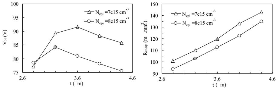
**Figuur 17** Doorslagspanning (links) en specifieke aan-weerstand (rechts) voor de niet-zwevende RESURF nLDEMOS met BLP in functie van de lengte van het veldoxide  $t$  en dit voor de hoogst mogelijke doperingsniveaus voor de n-epi. De gevulde datapunten tonen het optimum voor elk van deze doperingsniveaus.
