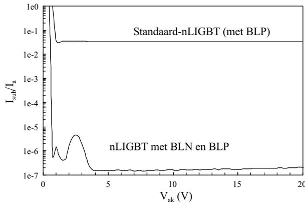
**Figuur 33** *Gemeten* verhouding van de substraatstroom tot de anodestroom voor  $V_{gk} = 3.3 \text{ V}$  van een zwevende nLIGBT met BLN en BLP, vergeleken met een niet-zwevende nLIGBT met BLP.
