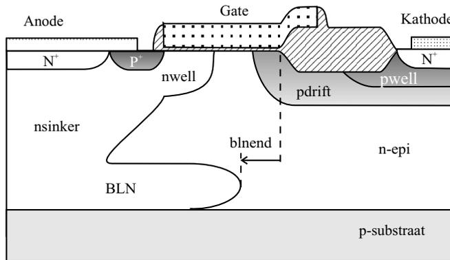
**Figuur 34** De zwevende pLIGBT met nsinker en BLN.
