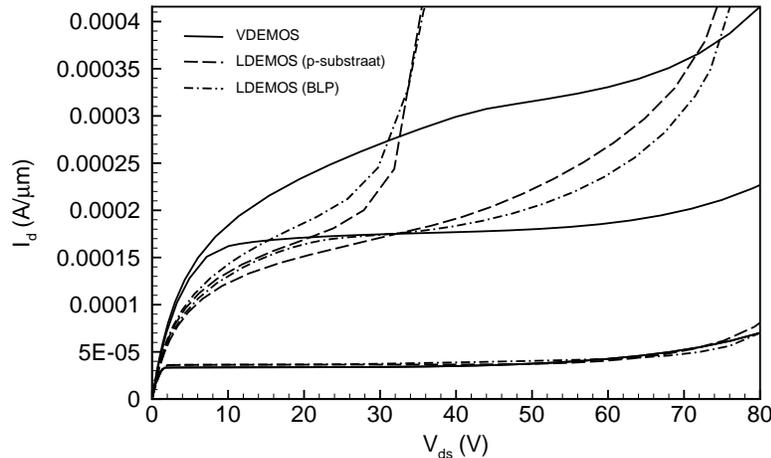
**Figuur 21**  $I_d(V_{ds})$  karakteristieken voor  $V_{gs} = 1.1, 2.2$  and  $3.3$  V voor de best presterende nVDEMOS en voor de RESURF nLDEMOS structuren op een n-epi met  $N_{epi} = 4e15 \text{ cm}^{-3}$  (zie tabel 2).
