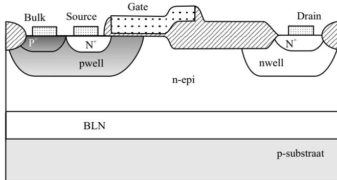
**Figuur 18** De zwevende, laterale niet-RESURF nDEMOS op een n-type begraven laag (BLN).
