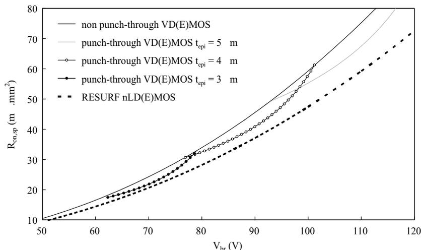
**Figuur 13** De siliciumlimieten voor NPT en PT nVD(E)MOS en voor de laterale RESURF nD(E)MOS.
