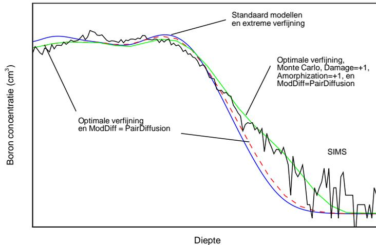
**Figuur 9** Vergelijking van het SIMS-profiel van de pwell na gate-oxidatie met verschillende gesimuleerde profielen.
