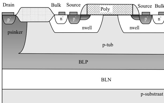
**Figuur 14** Geïntegreerde verticale pDMOS.
