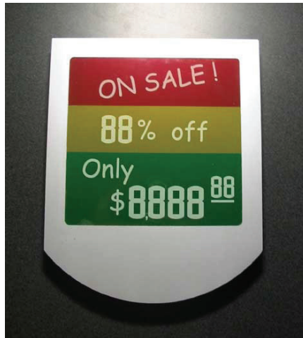
Figuur 3 Bichromaal niet-zwart/wit 1-pigment EPID.
